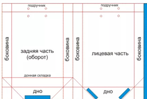
Конструкция бумажного пакета (штанц-форма для высечки с одного печатного листа)
